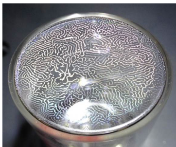
図 C.2: コロイド溶液の乾燥により得られる特異な構造。粒子濃度が薄い場合や積層できるほど濃い場合には観察することができない。
