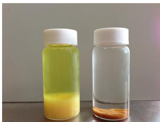
Fig. 6.6 A1 集水桝から採取した滞留水 左が黄色を呈している部分から採取した試料、右がオレンジ色部分の試料
