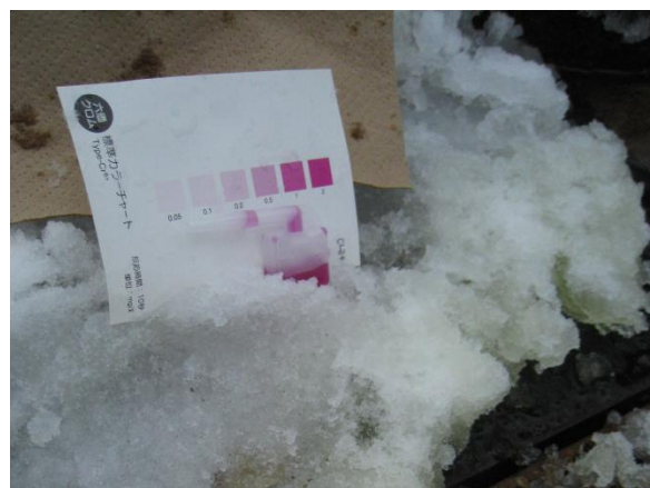
Fig. 6.6 雪試料の Cr(VI)簡易テストの様子
