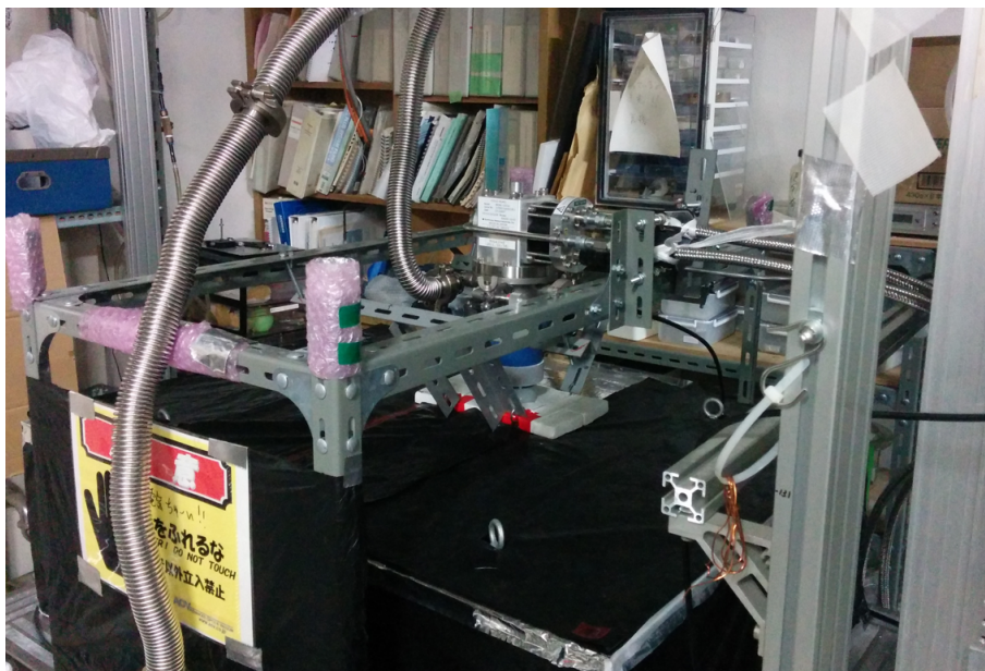
図 2.14: テラヘルツ測定に用いる冷凍機とそれを吊る架台.
