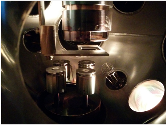
図 2.3: (左上) 新チャンバー系の写真, (右上) RHEED 用の蛍光スクリーンと CCD カメラ, (左下) ターゲットホルダと加熱空間, (右下) 基板ホルダと金属マスク.
