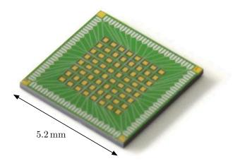
Fig. 5.4  $8 \times 8$  TES array
