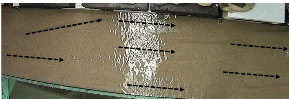
図 3-5 実験開始直後に形成された 4 列の多列砂州 (実験 E-2, 開始 4 分後)
