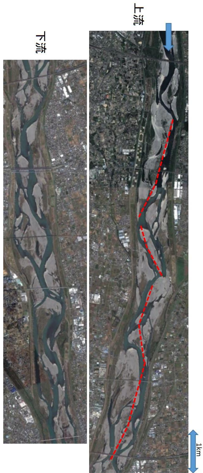
図 5-19 天竜川扇状地区間の網状流路の状況，下流側では二列蛇行が卓越している
