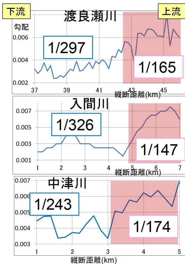
図 5-17 各河川の縦断的な勾配の変化（四角で囲んだ数字は各区間の勾配の平均） 縦断距離について入間川は初雁橋からの距離，中津川は中津川橋からの距離
