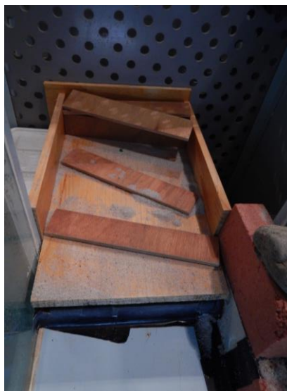
図 3-4 水路上流端では木枠の中で土砂を横断方向に均一に均してから給砂した
