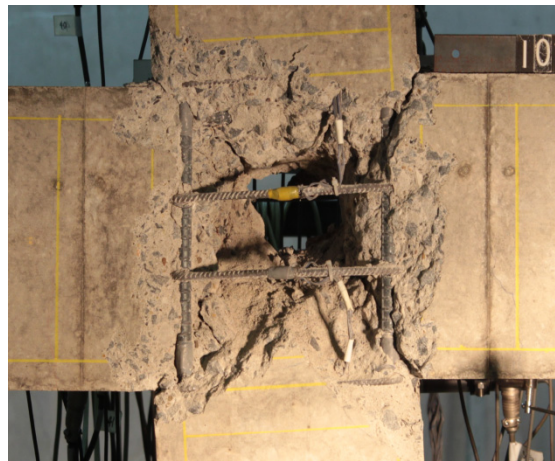
写真4.1 I01の損傷状況 (層間変形角7.0%) [4.2]
