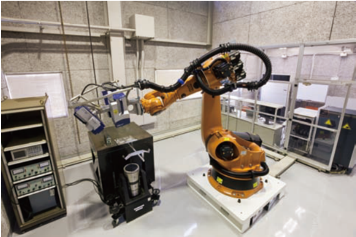
図 6.1: 多軸振動非接触自動計測システム MaVES
