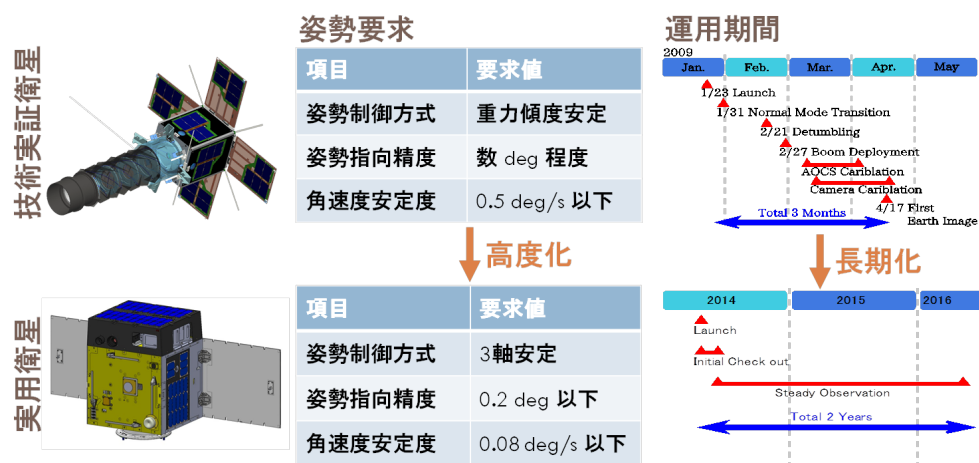
図 2.3 技術実証超小型衛星と実用超小型衛星の比較
