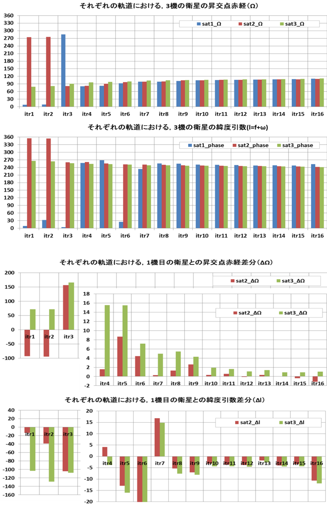
図 24 16 種類の軌道配置における, 各衛星の昇交点赤経と緯度引数
