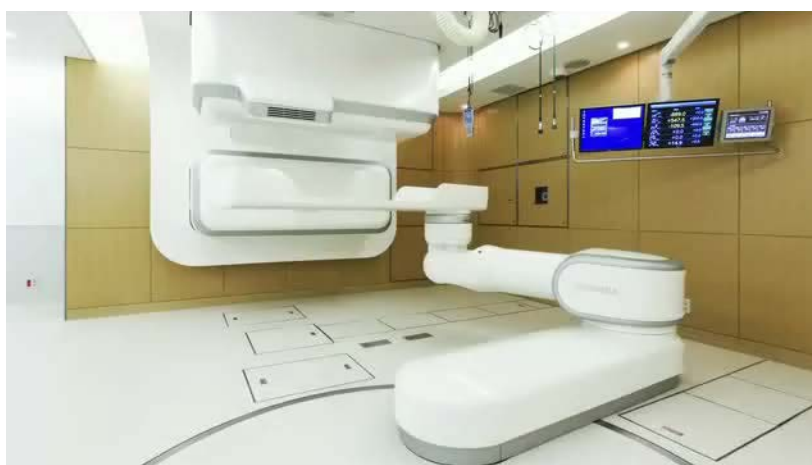
図 13 放医研新治療棟に導入されたスキャニング照射装置
