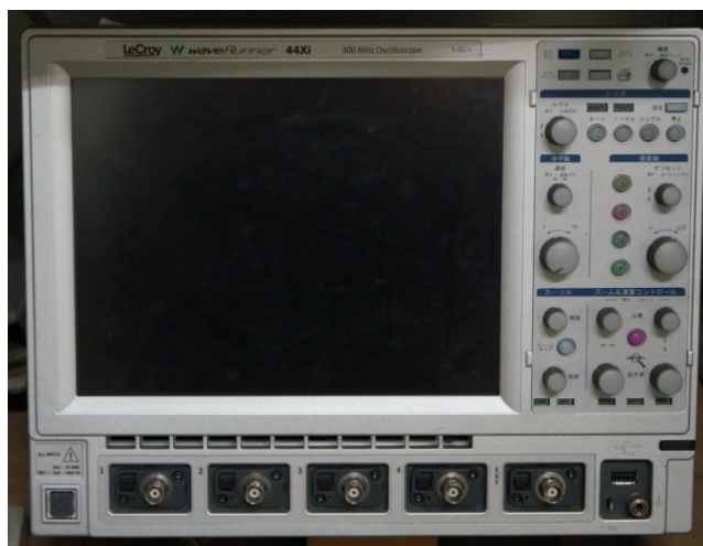
図 4.34 磁場測定用及び RF 実験測定用のオシロスコープ
