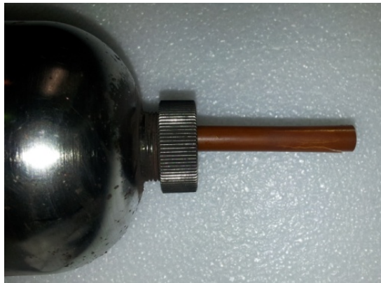
図 4.20 衝撃波による破壊の例（ベークライト部分に亀裂が入っている。）
