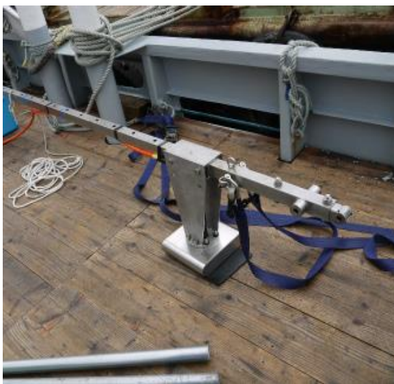
Fig4-5 計測ポールへの SES2000 の取り付け
