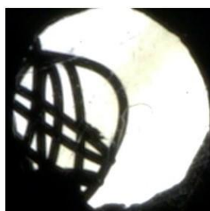
図 4-40 固体形状の経時変化 (実廃棄物 温度履歴あり, 25 MPa, 酸化剤なし)
