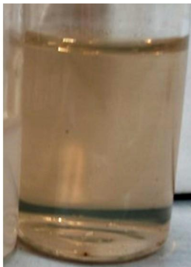
図 4-5 処理後回収物の外観 (400 °C, 25 MPa, 酸化剤あり)
