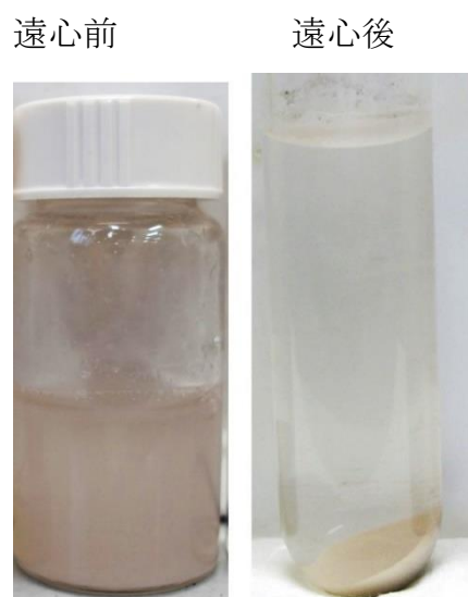
図 4-22 処理後回収物の外観 (400 °C, 25 MPa, 酸化剤あり)
