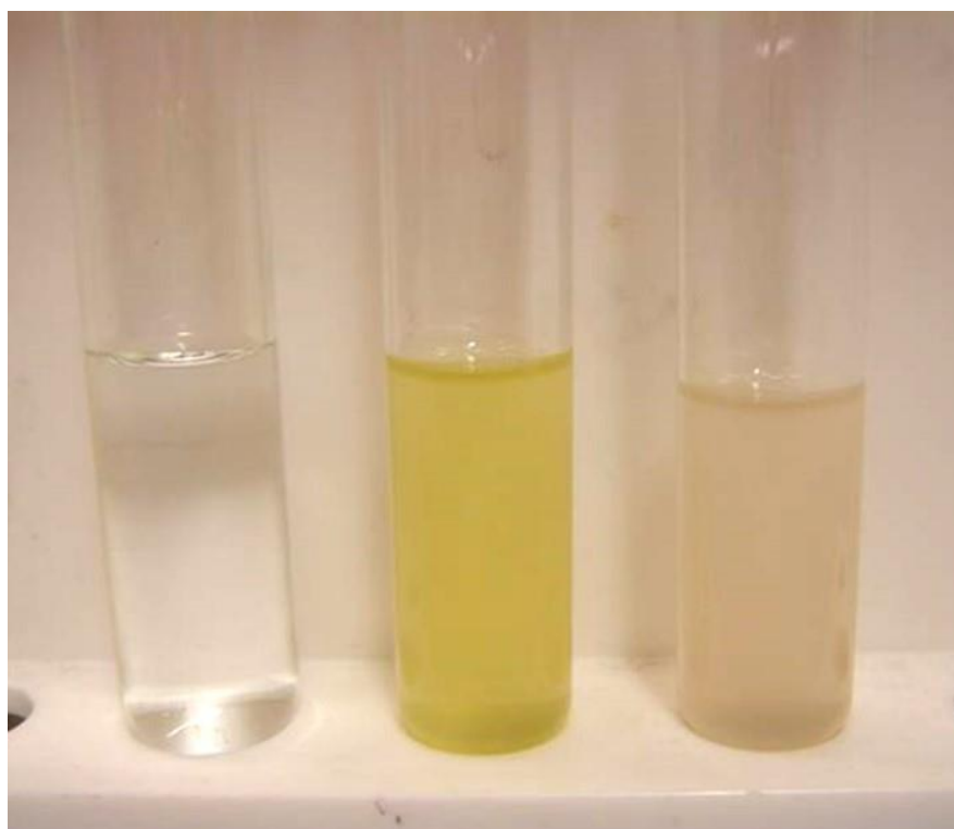
図 5-23 モリブデンイエロー法による発色試験結果 (380 °C, 25 MPa, 5 min air)
