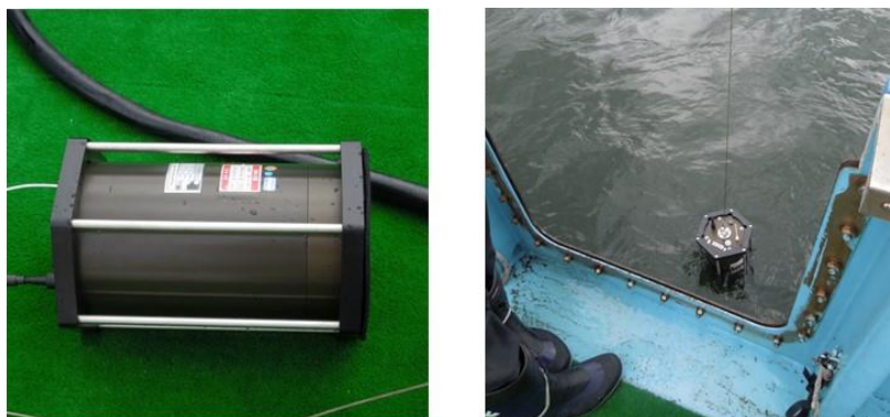
図-2.7 Hydroscat-6P と後方散乱係数測定時の様子
