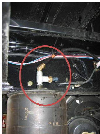
図 4.5 ベローズ圧力センサ (Sensor 3)
