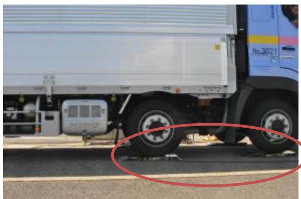
図 4.3 Force Plate センサ (Sensor 1)
