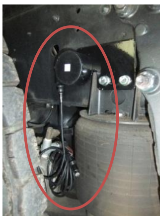
図 4.4 ストロークセンサ (Sensor 2)
