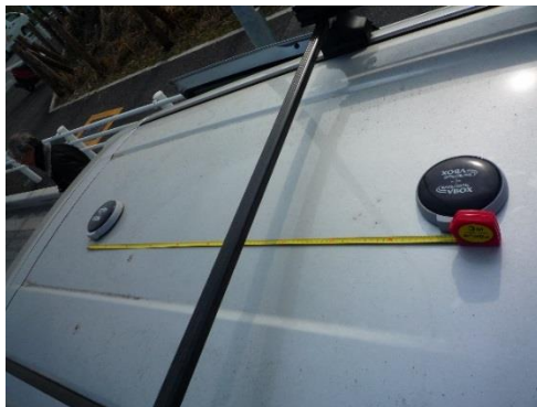
図 4.26 GPS センサの設置
