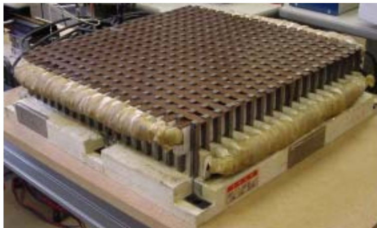
図 1.9 X-Y LIM の電機子の構造 (日本大学) [15]
