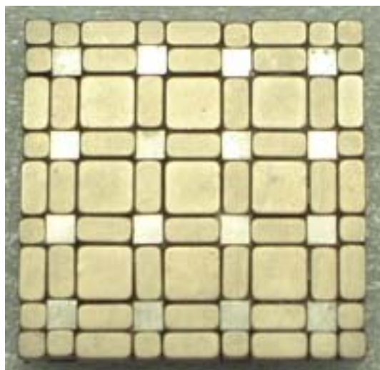
図 2.4 2次元ハルパツハ型永久磁石配列の概観
