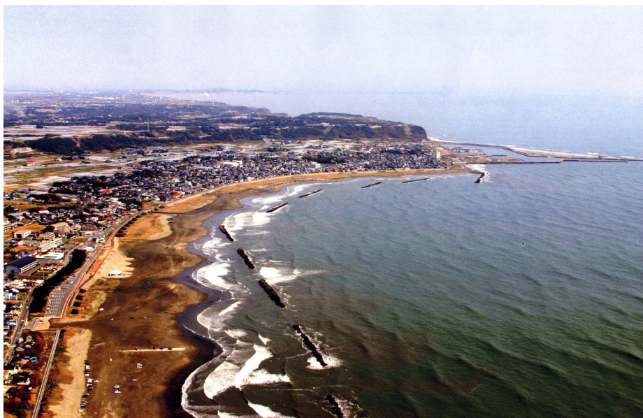
図-3.1.3 砂浜が戻り成功した飯岡海岸
