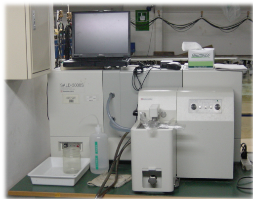
図 3.3.1.2 使用した島津製 SALD-3000 型レーザー回折式粒度分布測定装置
