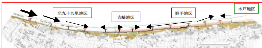
図 4.1.1.1.13 北九十九里浜、漂砂の卓越方向(千葉東沿岸海岸保全基本計画資料に加筆)
