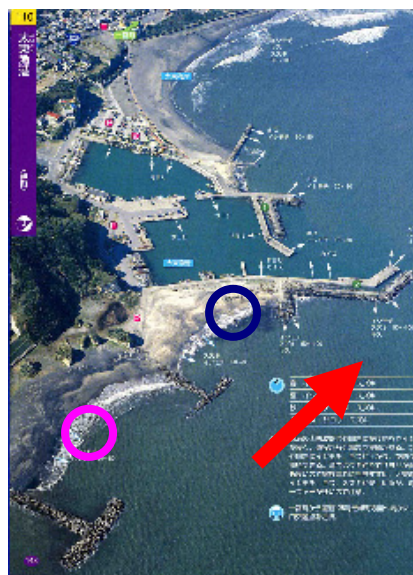
図 4.1.1.2.11 南側から強い北向きの流れを示す粒度分布と採砂地点○印、流れの方向(右)
