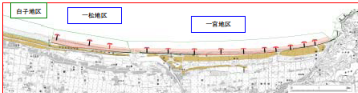
図 4.1.1.2.1 一松地区～一宮地区までのヘッドランド計画。赤印は、工事中を示す。
