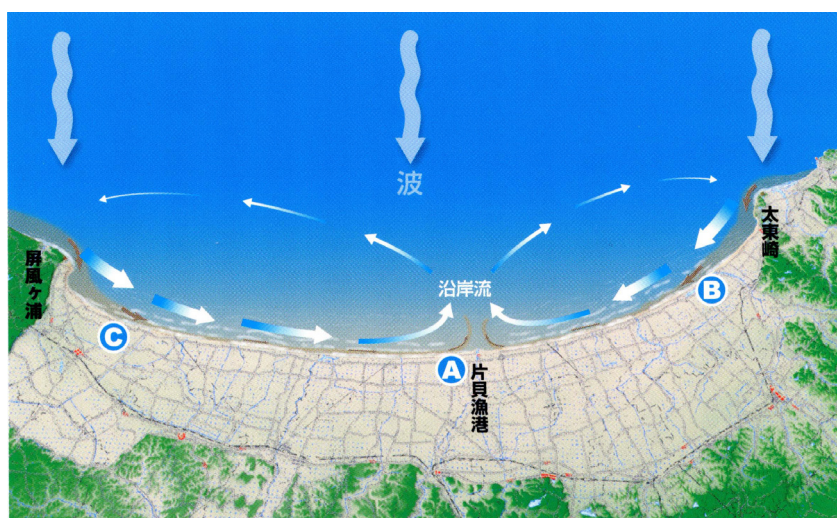
図-1.3.1.2 九十九里浜の沿岸漂砂の模式図 2)
