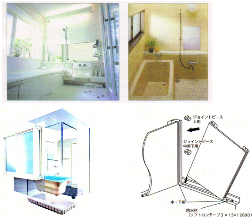
図 3.7 現在のデザインと構法（左）と 20 年前のデザインと構法（右）
