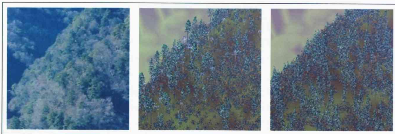
図-5.2.2.2. 部位Aの拡大画像（左-実写真、中央-本研究の手法、右-既往の手法）
