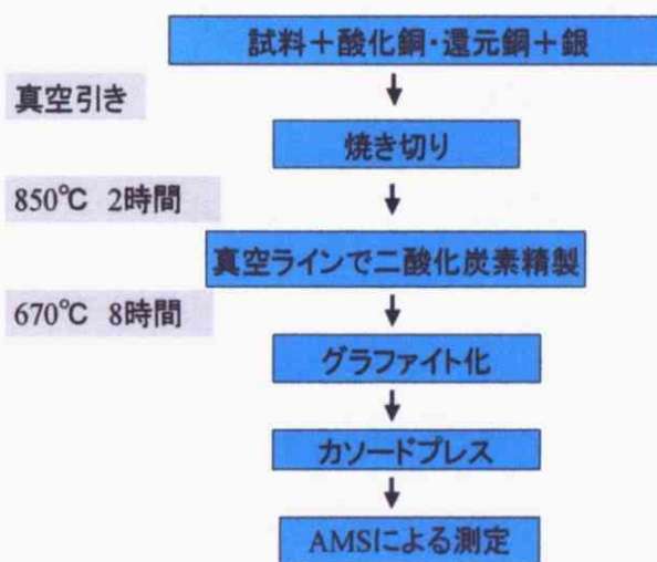
Fig.3-2-2 ^{14}\text{C} 測定手順
