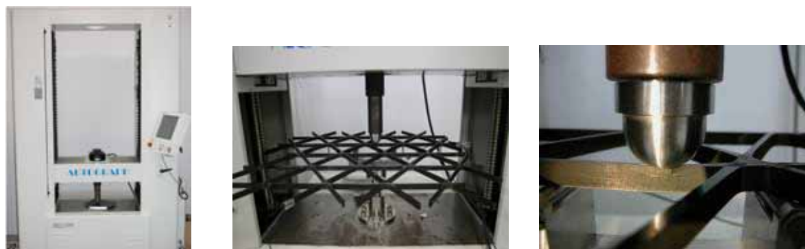
Fig. 4.2 繊維破断によるクラックの導入方法
