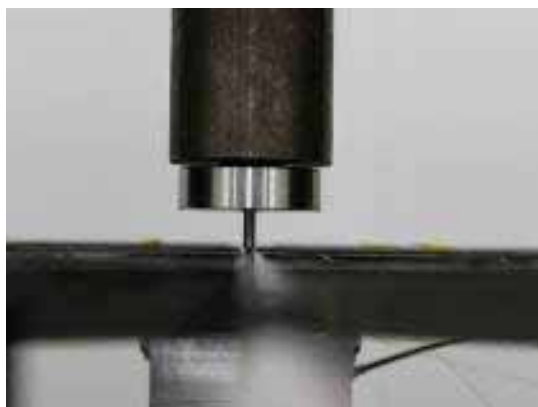
Fig. 5.6 スプリットングの導入に用いた押し込み治具
