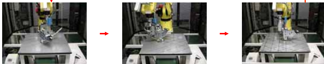
Fig. 1.3 自動積層装置による積層方法
