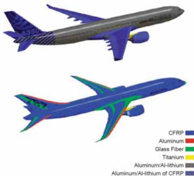
Fig. 1.2 A350-900 およびBoeing 787 に用いられる構造材料の比較 (Copyright:www.NowHow.nl, 2006)
