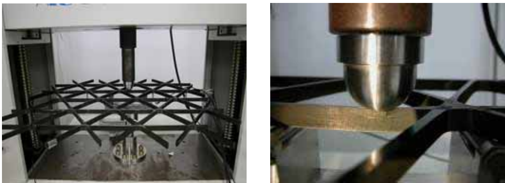
Fig. 5.2 繊維破断によるクラックの導入方法
