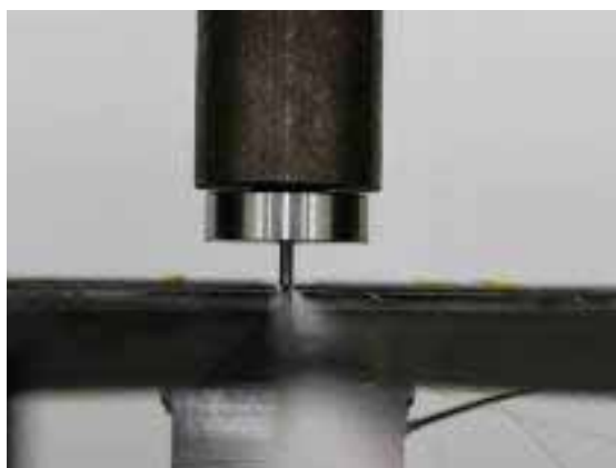
Fig. 4.8 スプリッティングの導入に用いた押し込み治具
