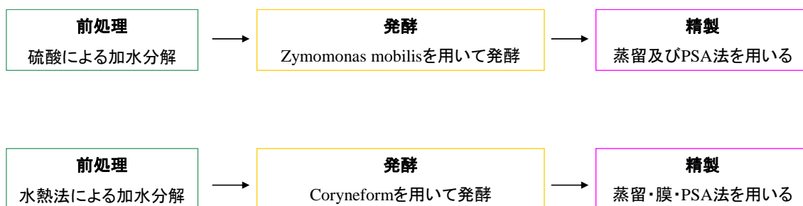
図4.1 エタノール製造プロセスフロー図(上段がNRELプロセス、下段が山田らのプロセス)
