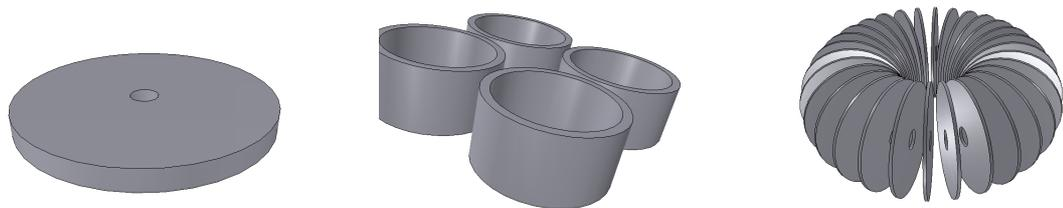
図 3.6: Bi系線材 30K における設計図
