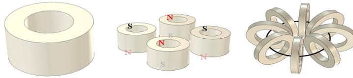
図 2.2: 各種コイル形状とその組み合わせコイル外径 : ソレノイド型 (左), マルチポール型 (中央), トロイダル型 (右)
