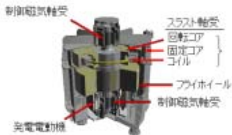
図1 フライホイールエネルギー貯蔵装置
