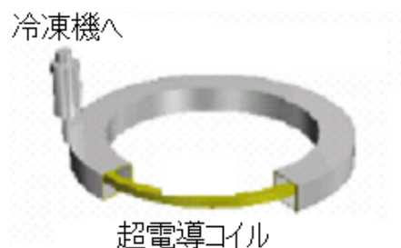
図6 超電導コイル
