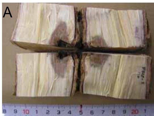
図 1. 冬期付傷のコナラを 6 ヶ月後に割材し、観察した例。 A.軸方向に割材。 B.接線方向に割材、巻き込みが認められる。
