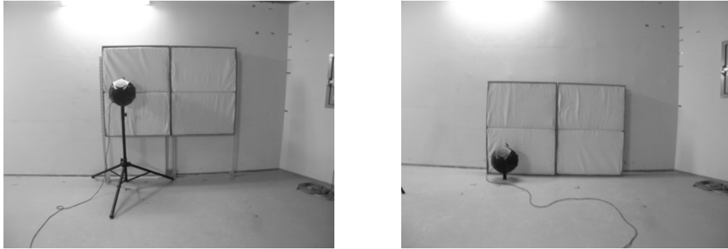
図 3.12 : -h と-l のときの音源・吸音面配置の違い (左 : F-h、右 : F-l)
