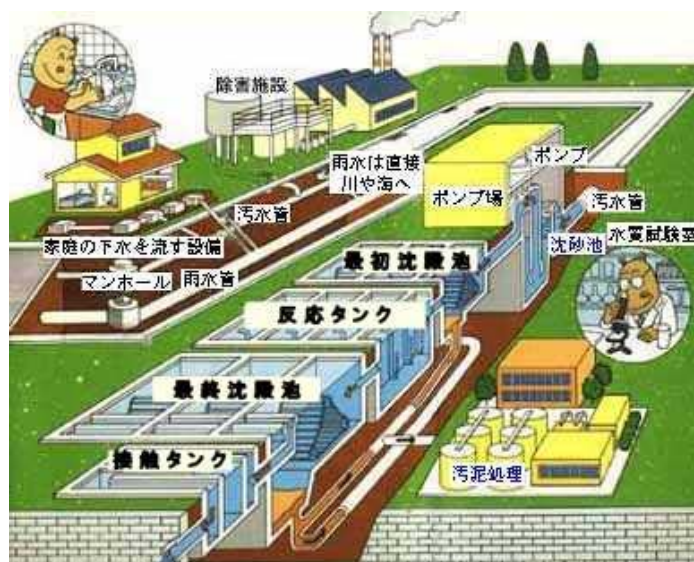
図 28 下水処理施設
