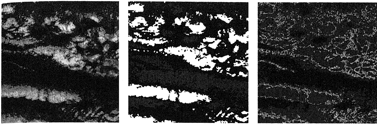
(a) 気象衛星 NOAA の赤外バンド (Ch.4) 画像 (b) ピュアピクセルのみを表示した結果 (c) ミクセルのみを表示した結果 (濃淡はクラス1の面積占有率に比例)
