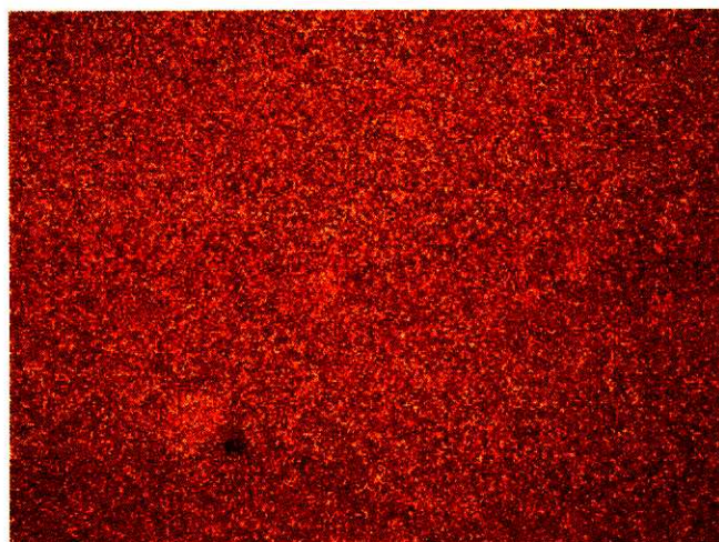
図 3-12: Si 基板上に電子銃蒸着装置によって Ti(100nm)/Ni(100nm)/Au(100nm)を蒸着した後、抵抗加熱蒸着装置によって 6-8 \mu\text{m} の AuSn を直接蒸着したサンプル。抵抗の過熱による輻射熱は図 3-11 のように AuSn を酸化させてしまう。酸化を防ぐためには 30 秒加熱を行い 5 分冷却を行う操作を繰り返す。
