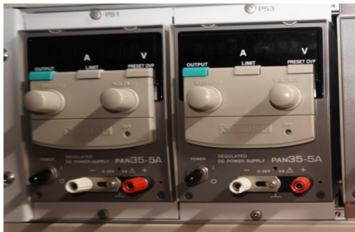
(c) コイル電源(左：インナー・アウター用，右：トリム用)
