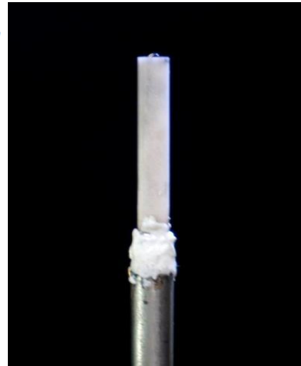
図 3.14 エミッシブプローブの断面図(左)と写真(右)
