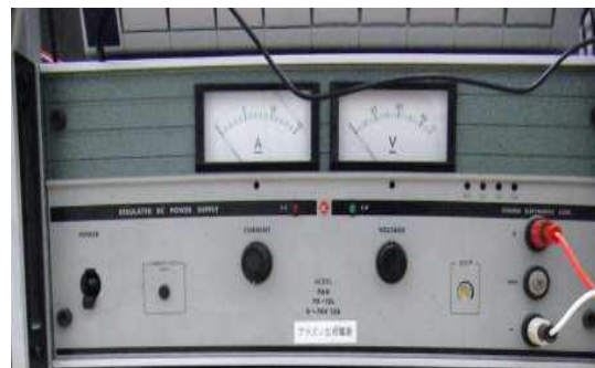
(c) コイル電源(左：インナー・アウター用，右：トリム用)
