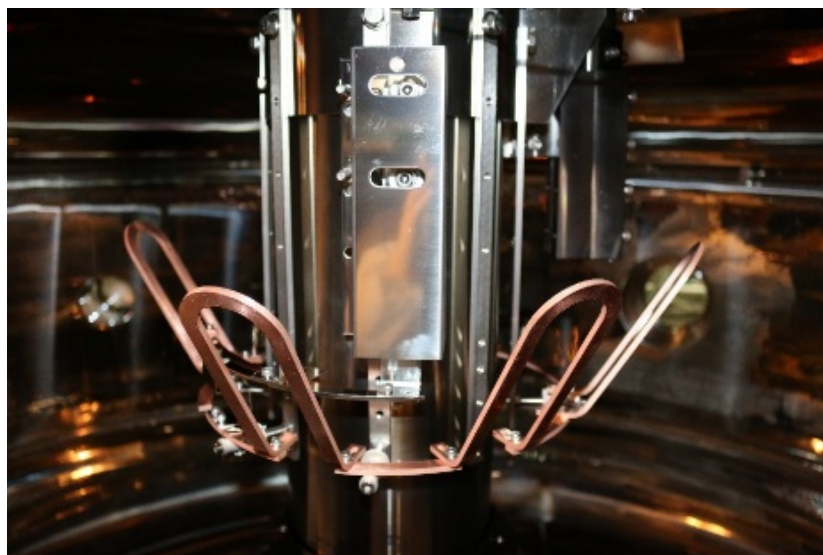
図 4.5 (cap-shape) antenna(loop antenna の間に6つの (cap-shape) が備え付けられている)
