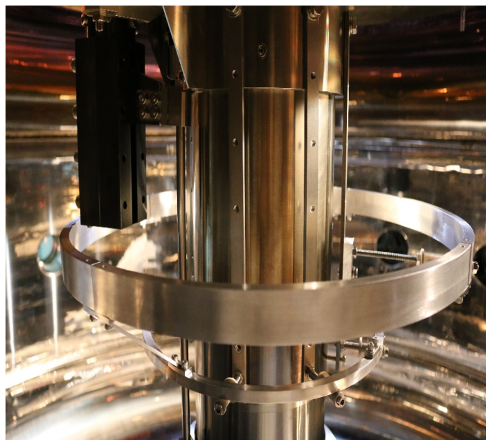
図 4.6 double-loop antenna(上下に二つの loop antenna を設置している)
