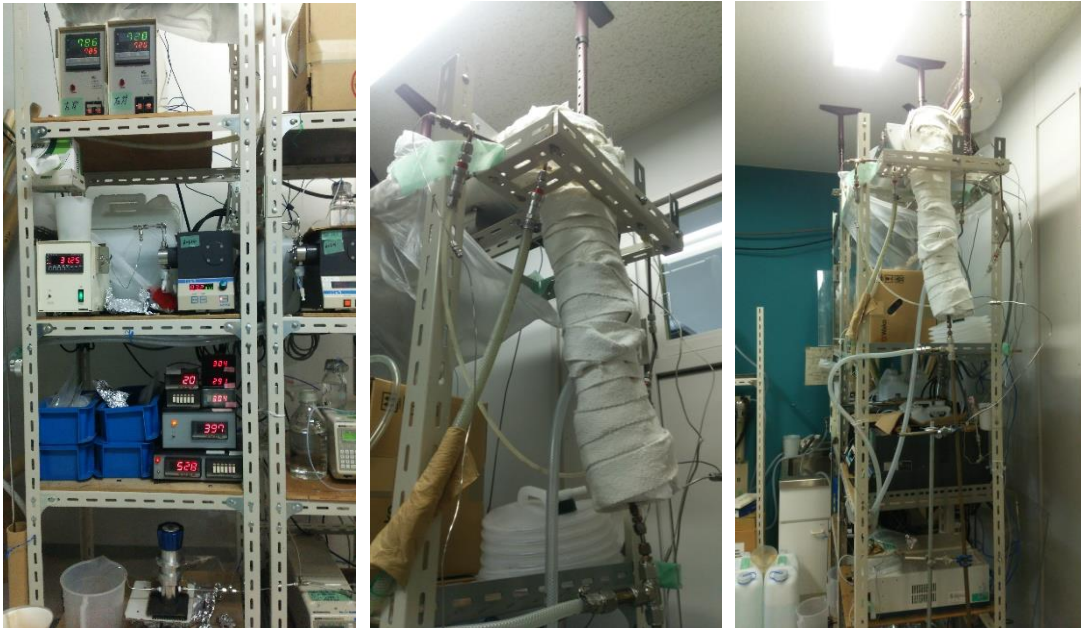
図 2.2 流通式装置 左から制御部, 反応管, 全体
