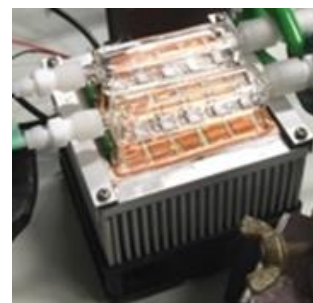
図 9 自作した紫外 LED コンバータ 寸法 10×10×14 cm 重量 1 kg 電源寸法 30×12×3 cm 重量 200g
