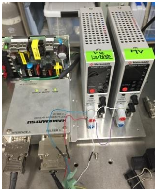
Figure 31 レーザー用電源、温調ユニット( 左手前 :TEC コントローラー 中央 :Vic 電源 右 :HV 電源 )
