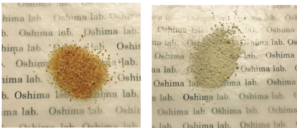
図 4.24 反応後の触媒の写真(左: 250°C, 右: 400°C)
