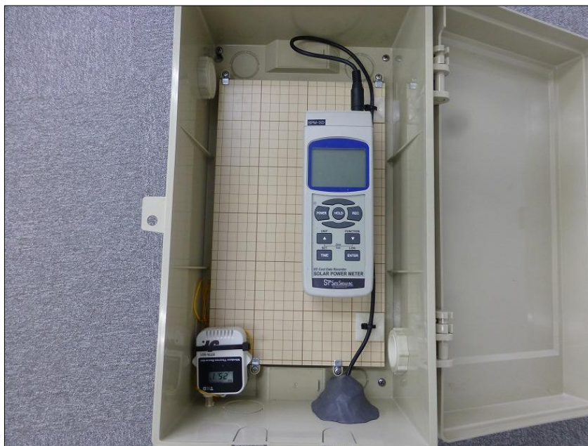
Figure3.3 : 気象観測装置の内観（左下：温度計，右上：日射計）
