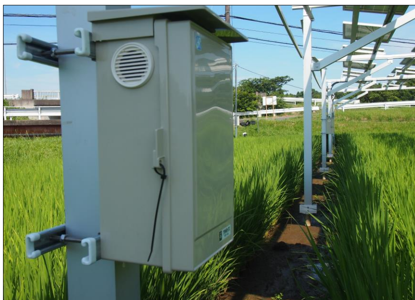
Figure3.4 : 酒々井実証サイトに設置した気象観測装置
