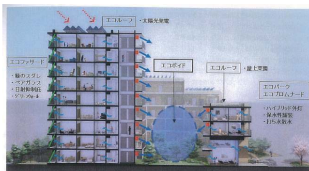
【図 3-28】断面図で見る環境配慮技術 調査時頂いた資料より
