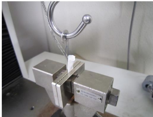
図 4. 周軸強度試験および吻合保持強度試験の測定方法 (シェーマ及び測定機器写真) 周軸強度試験
