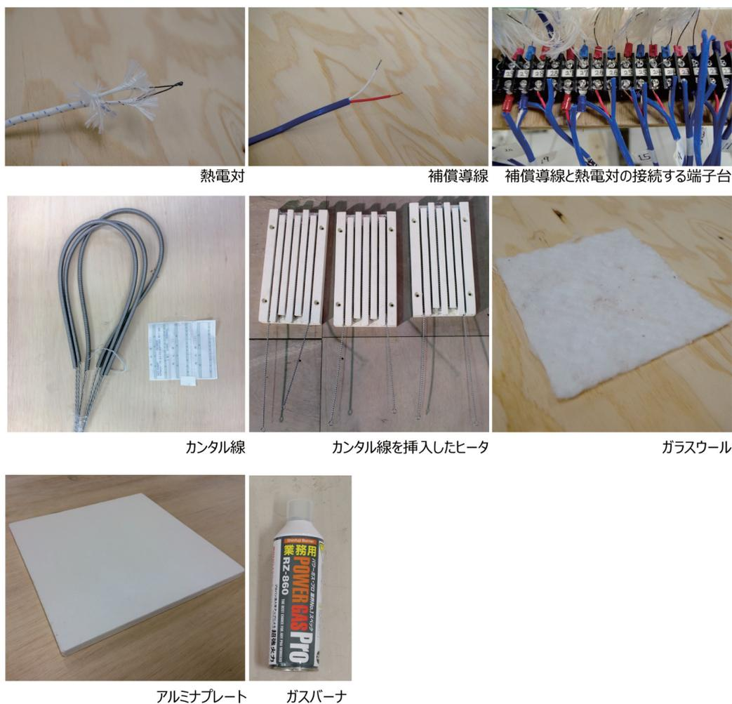
図 21 溶着炉の構成要素写真
